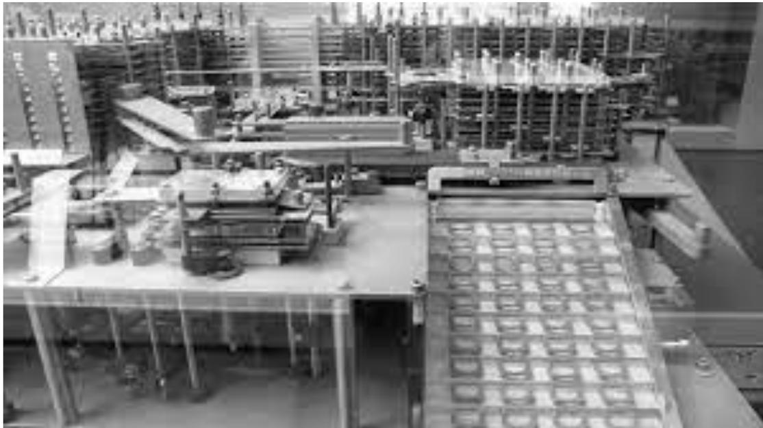
El Z1 está considerado como el primer computador mecánico programable del mundo. Fue diseñado por el ingeniero alemán Konrad Zuse entre 1935 y 1936, construido entre 1936 y 1938, y destruido junto a todos sus planos de construcción en diciembre de 1943 durante el bombardeo aliado de Berlín en la Segunda Guerra Mundial.
